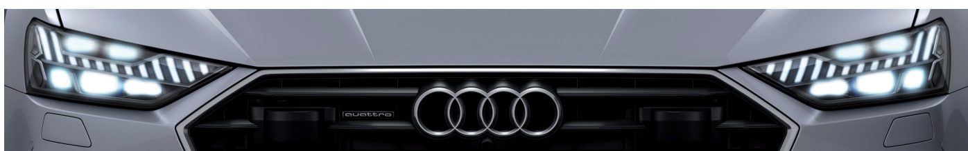
Дальний свет + лазерное освещение
