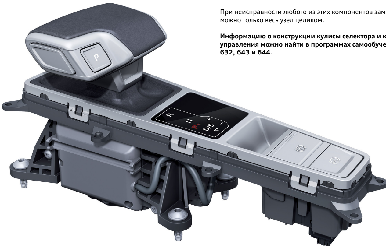
Функциональная схема кулисы селектора
